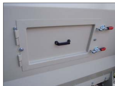
Trappe de visite sur arrière de crible
