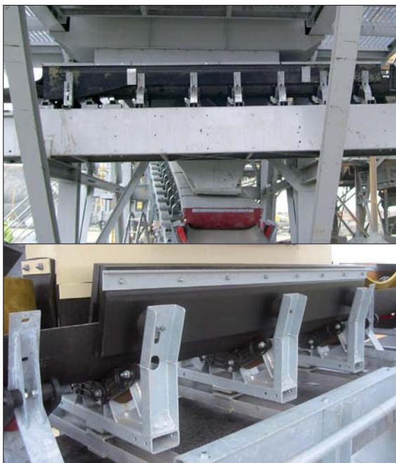
Transporteur à double sens avec système de centrage automatique
